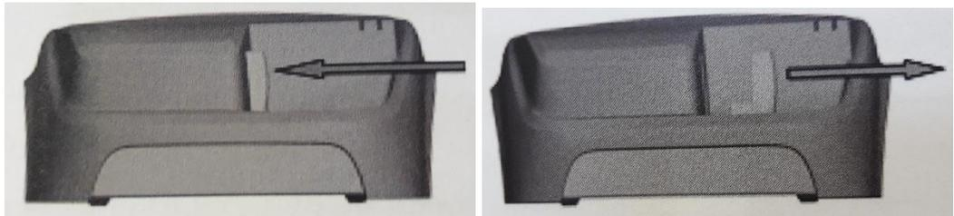
6.46.2 Encaixe o cartão DG Gel processado no suporte de cartão para ser lido. O código de barras deve estar voltado para trás do DG Reader. Certifique-se de empurrar o cartão DG Gel para baixo e para direita, firmemente, até que esteja totalmente encaixado.
